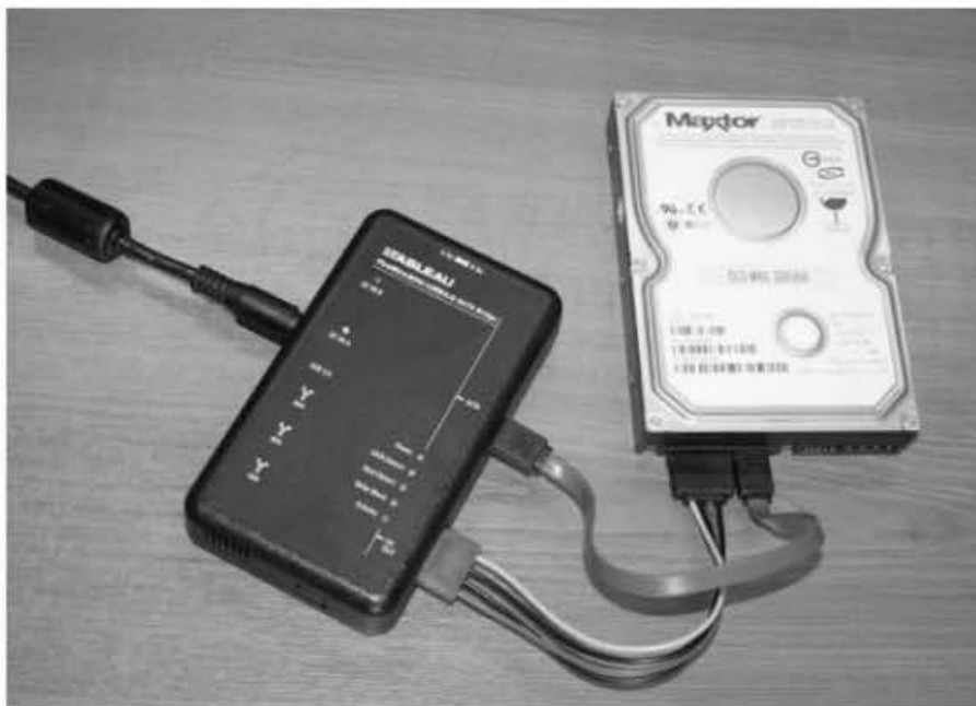
Gambar 4.13 Portable tableau forensic write-blocker yang tersambung pada harddisk
