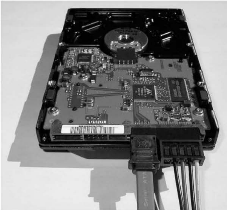
Gambar 4.12 Serial ATA hard disk yang akan didiskoneksi dari kotak CPU (Sumber: Wikipedia. Thomas Rosenau. Serial ATA hard disk connected)
