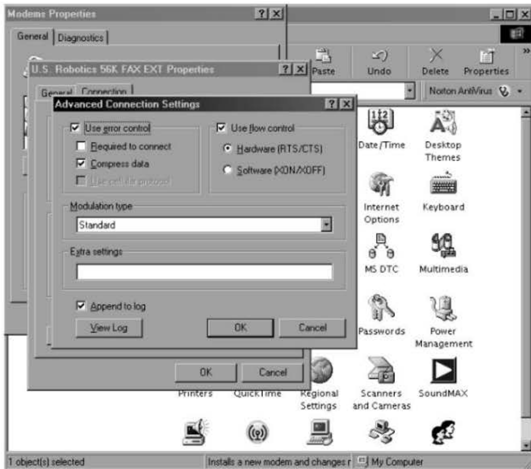
Gambar 6.1 Mekanisme pengaturan koneksi modem
