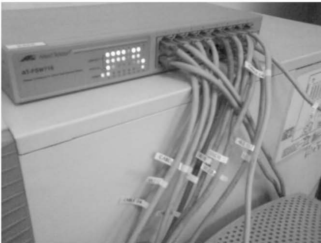
Gambar 7.10 Switch dengan Kabel UTP yang dinomori
